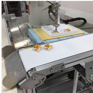
こちらは、「搬送工程」を想定したビジョントラッキングシステムです。ロボットと二次元ビジョンセンサとコンベアを組み合わせています。ビジョンセンサでコンベア上をランダムに流れるワークを検知し、コンベアを止めることなく、ロボットがワークの搬送・整列を行います。ビジョンセンサを活用すれば、多品種のワークがある場合でも、ワークごとの専用整列装置なしで、低コストに汎用的なシステムを構築することができます。狭い場所で搬送したい、人の手による重労働を改善させたいなどの課題をかかえていらっしゃるお客様への提案が有効です。三菱電機 の条件で算出した数値によると、搬送効率150%改善されます。採用事例は包装食品のコンベア整列システムなどがあります。
