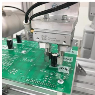
こちらは、「組立工程」を想定したデモです。ロボットと力覚センサを組み合わせています。ロボットがコンデンサをつかみ、基板の穴に差し込む動作をします。穴でない部分に触れた場合、一度持ち上げ、1ミリずらした位置で再度差し込む動作をします。二本の脚を基板の穴に差し込めるまでこの動作を繰り返します。このように力覚センサは物に当たったり、触れたりした時に生じる負荷を感知できるので、人が手が行う作業で無意識で行っているような微調整が可能となります。導入メリットは高精度のロボットにより正確な組立が行える点や24時間稼働ができる点などがあります。人の手作業によるムラやミスを改善させたいなどの課題をかかえていらっしゃるお客様への提案が有効です。採用事例は自動車部品研磨作業や機械部品加工機などがあります。
