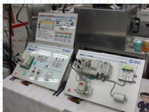
SMCの久保係長にご尽力いただき、無線システムのデモ用パネルを貸し出させていただきました。無線で電動アクチュエーターを制御できる為、配線がロボットの動きを邪魔しないスムーズな動きが可能です。
