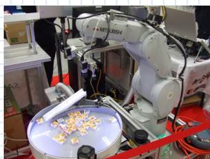
三光電業の客先である〇〇精機様の商品と三菱電機の垂直多関節ロボットの連携のデモです。IDECのレーザースキャナSE2Lも設置し、安全機器の必要性も併せて説明しました。
