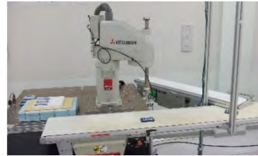
三菱電機 ロボット RH-65DH + 三菱電機 二次元ビジョンセンサ
