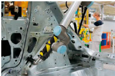
ユニバーサルロボットが実現した自動化の例：ねじ締め、検査
