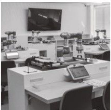
タブレット、制御ボックス、センサー付きのミニコンベヤ、スライダロボット
