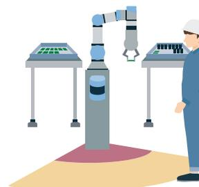
人の接近によりロボットの速度を減速または一時停止させることで、生産性と安全性を両立。赤いエリアに侵入してから、どれだけの時間/距離で停止するかを任意に設定が可能。より短い時間/距離で停止させることで、設備サイズをコンパクト化
